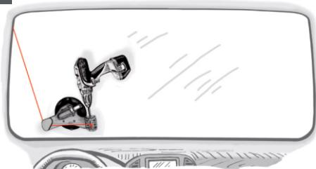
Bei erreichen der oberen rechten Ecke erneut Positionswechsel zur oberen linken Ecke (Abb. 5) danach Positionswechsel zur unteren linken Ecke (Abb. 6) und beenden Sie den Austrennvorgang komplett.
