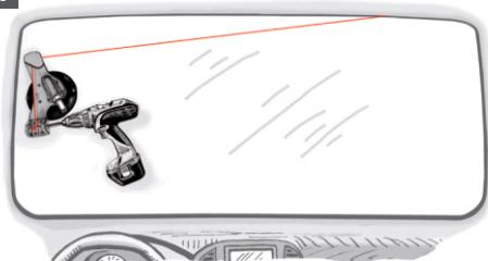
Akkuschrauber langsam rechts laufen lassen, dabei je nach Belastung die Drehzahl anpassen. Bei diesem Vorgang den Austrennschutz innen zwischen Scheibenaustrennschnur und Armaturenbrett- bzw. Holmen und Dachhimmel so halten, dass keine Schäden am Innenraum entstehen können. Den Trennvorgang nun so lange fortführen bis die Scheibenaustrennschnur die untere rechte Ecke erreicht hat.
