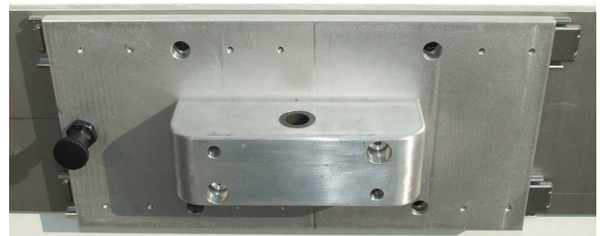
Fig. 15: Achteraanzicht kalibratiepaneel met schuifteenheid
