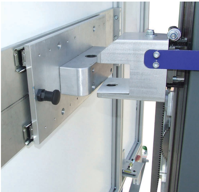
Fig. 15: Kalibriertafel Ansicht hinten mit Schiebeeinheit
