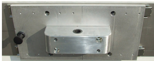
Obr. 15: Kalibrační tabule, pohled zezadu s posuvnou jednotkou
