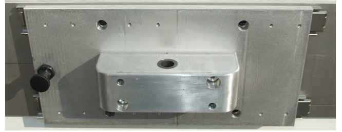
Şek. 15: Kalibrasyon paneli arkadan görünüm, itme ünitesi
