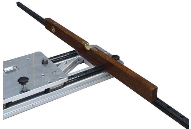
Fig. 24: Mise à niveau
