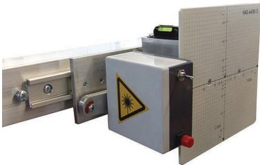
Fig. 12: Unidade de laser ACC montada
