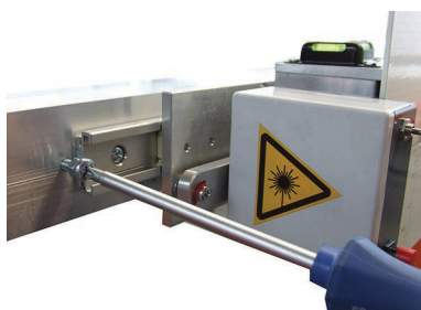
Fig. 11: Serraggio della vite
