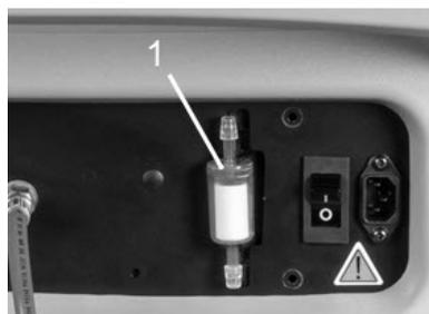
**Fig. 34 : Unité d'identification du fluide frigorigène**
