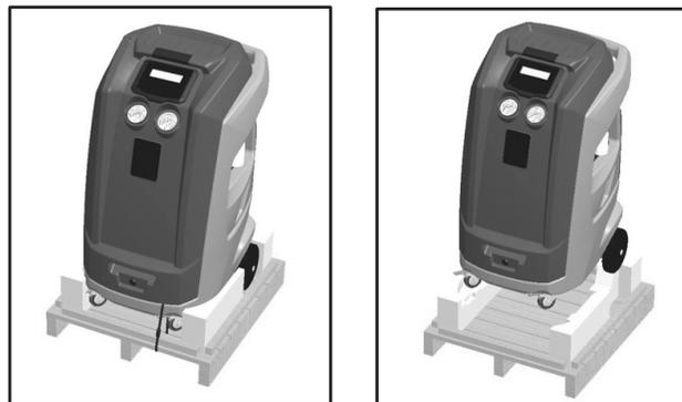
**Fig. 11 : Basculement de l'unité en arrière**
