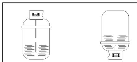
**Fig. 14 : Types de réservoirs de bouteilles de réfrigérant vierge**
